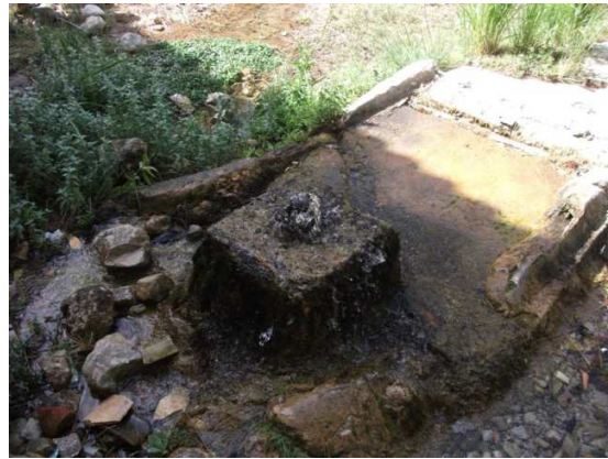
Foto 11. Piezómetro surgente en la zona de las pozas
