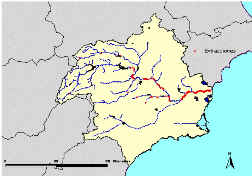
Figura 96 Extracciones mediante acequias. Fuente: Comisaría de Aguas
