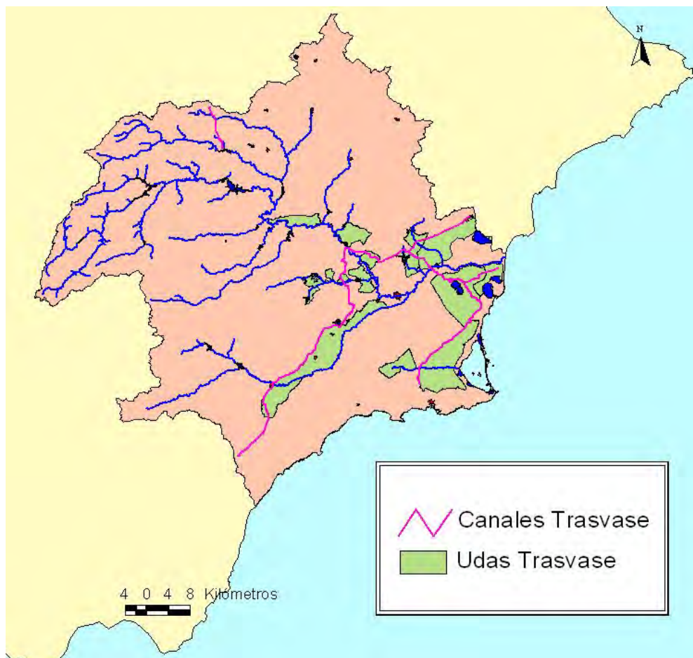
Figura 29 Canales del postrasvase Tajo-Segura y zonas de aplicación para riego de recursos del trasvase Tajo-Segura. Fuente: PHCS y Comisaría de Aguas.
