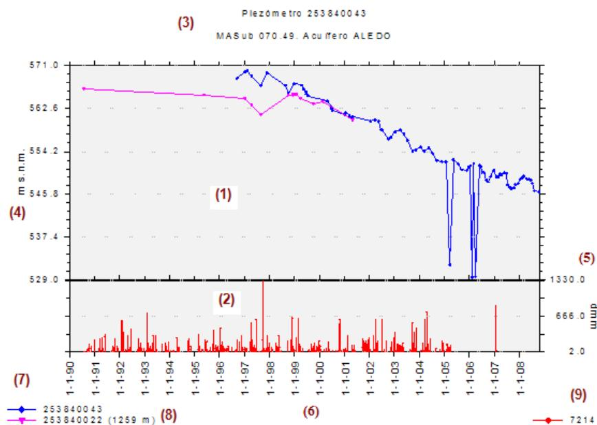
El área del gráfico aparece dividida en dos: una superior (1), en la que se presentan las evoluciones de las cotas piezométricas, y otra inferior (2) en la que se presenta la precipitación registrada en una estación meteorológica representativa.
