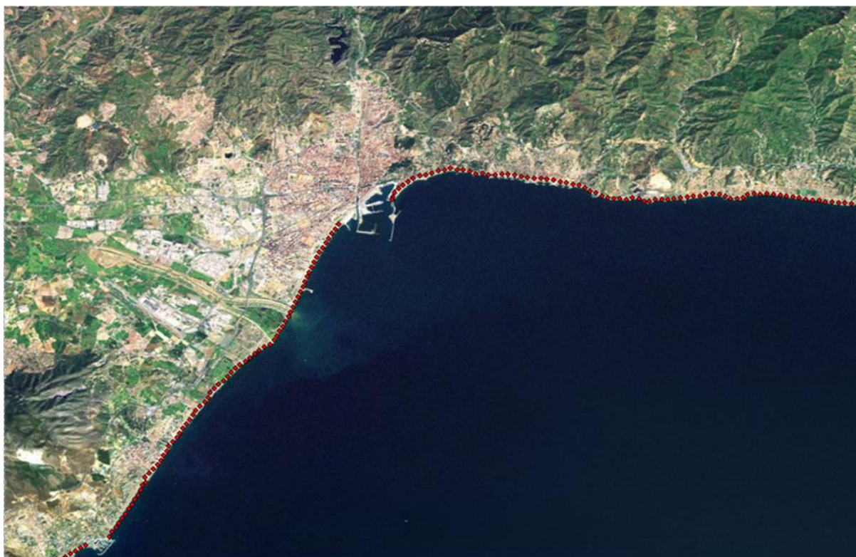
Figura 4. Ejemplo de la segmentación realizada en la línea de costa. Puntos rojos cada 200 m.
