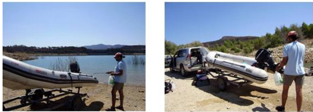
Figura 9.- Aplicación de solución desinfectante mediante atomizador portátil a la embarcación, motor fueraborda y remolque.
