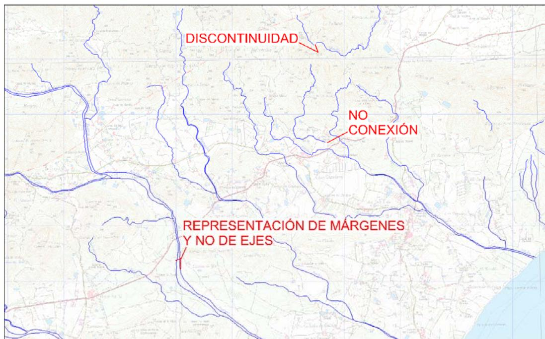
Fig. 1. Desconexión de corrientes y representación de márgenes en lugar de ejes= topología inválida (BCN25).
