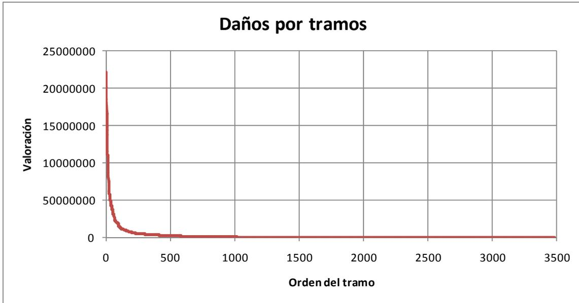
Fig. 39. Tramos clasificados por valoración de daños
