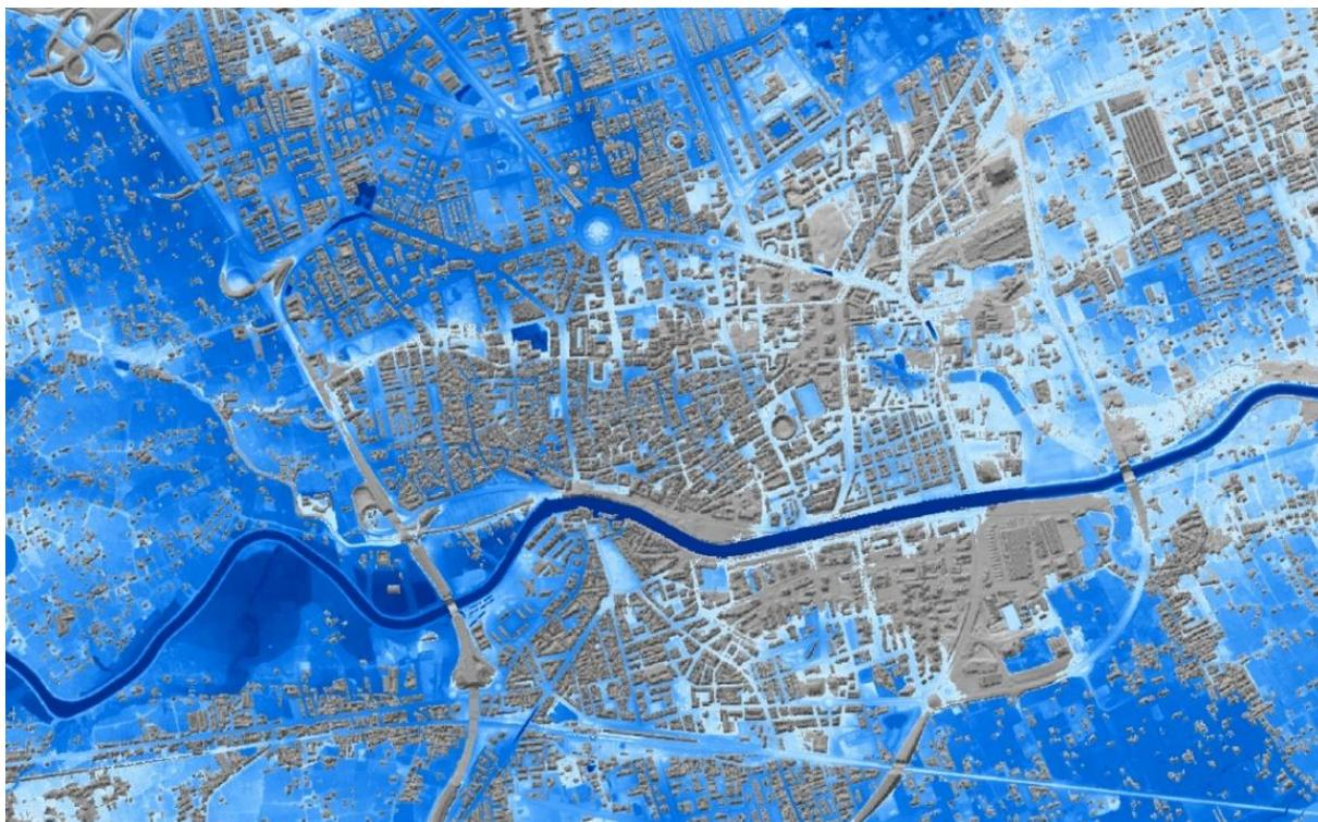
Figura 13. Cálculo hidráulico bidimensional realizado con el modelo GUAD 2D en Murcia. CH Segura. Fuente: Elaboración propia
