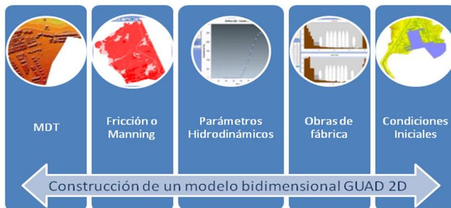
Como resultado de la modelización hidráulica se obtienen unos ráster de niveles (además de calados y velocidades), a partir de los cuales, sobre el Modelo Digital de Terreno se definen las áreas de inundación para las diferentes hipótesis de crecida cuyas características fueron definidas en el correspondiente estudio hidrológico.
