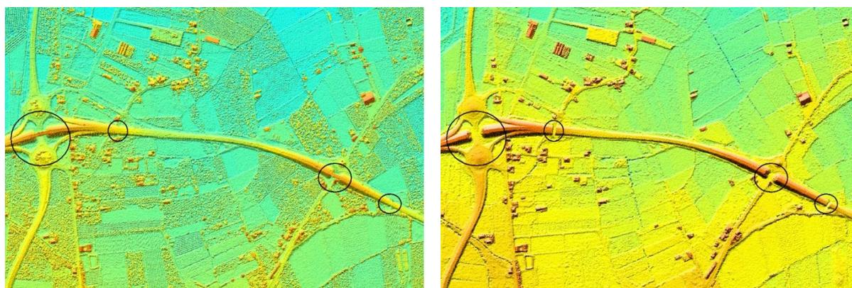
Figura 9. Detalle del Modelo Digital de Superficies, es decir con edificios y con puentes (puentes identificados con un círculo negro)
