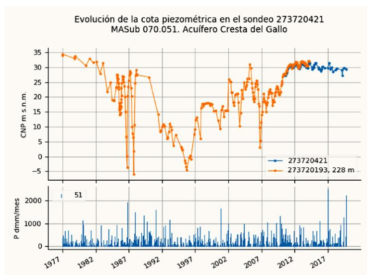
**Figura 2.** En cada figura se presentan dos gráficos. El gráfico superior representa la evolución temporal de la cota del nivel piezométrico CNP, en m sobre el nivel del mar. El piezómetro actual se representa siempre en azul y puede ir acompañado por otro que fue sustituido por el activo; en este caso, se incluye la distancia que lo separa del piezómetro actual, en metros.
