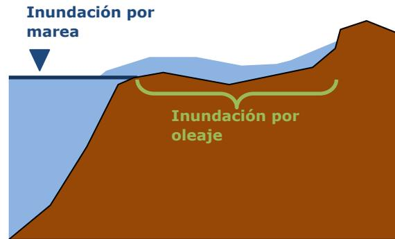
Figura 35. Esquema de inundación por marea e inundación por oleaje.
