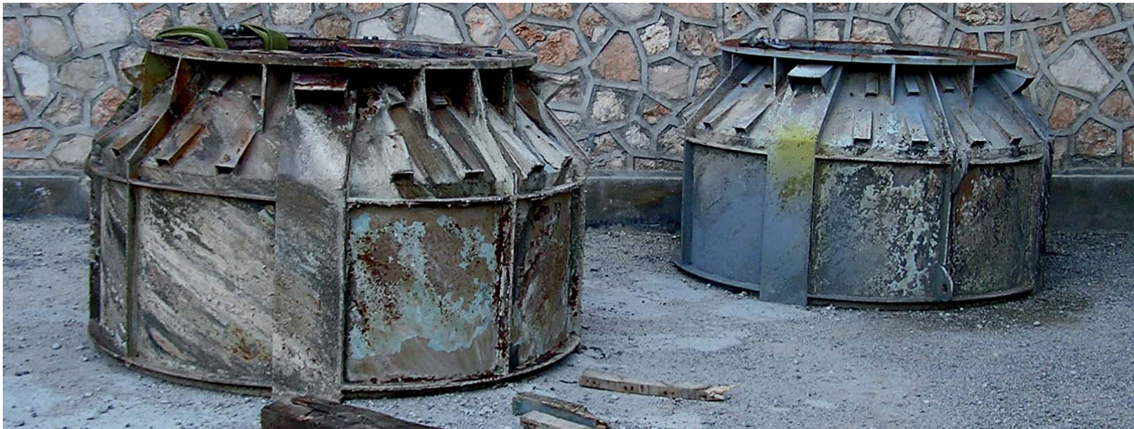
Concentradores de las válvulas Howell-Bunger sustituidos en el desagüe de la toma intermedia del embalse del Cenajo.
