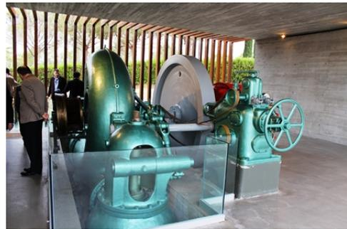
Una de ellas es la instalación de un pabellón de 130 m cuadrados en la zona del “museo del agua” donde se expondrá de modo permanente la turbina PELTON, procedente de la presa del embalse del Talave (cuya construcción finalizó en el año 1918, con la central a pie de presa del año 1942); permitiendo a los visitantes el estudio y contemplación de este elemento representativo del patrimonio histórico industrial de las obras hidráulicas.
