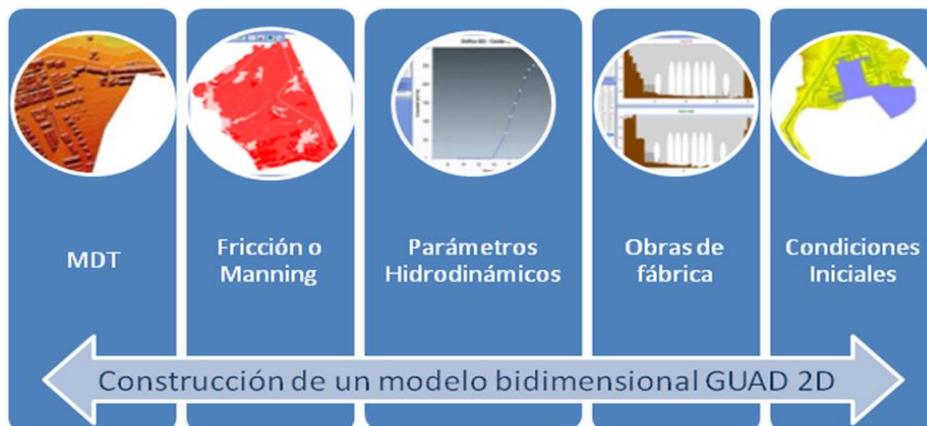
Como resultado de la modelización hidráulica se obtienen unos ráster de niveles (además de calados y velocidades), a partir de los cuales, sobre el Modelo Digital de Terreno se definen las áreas de inundación para las diferentes hipótesis de crecida cuyas características fueron definidas en el correspondiente estudio hidrológico.
