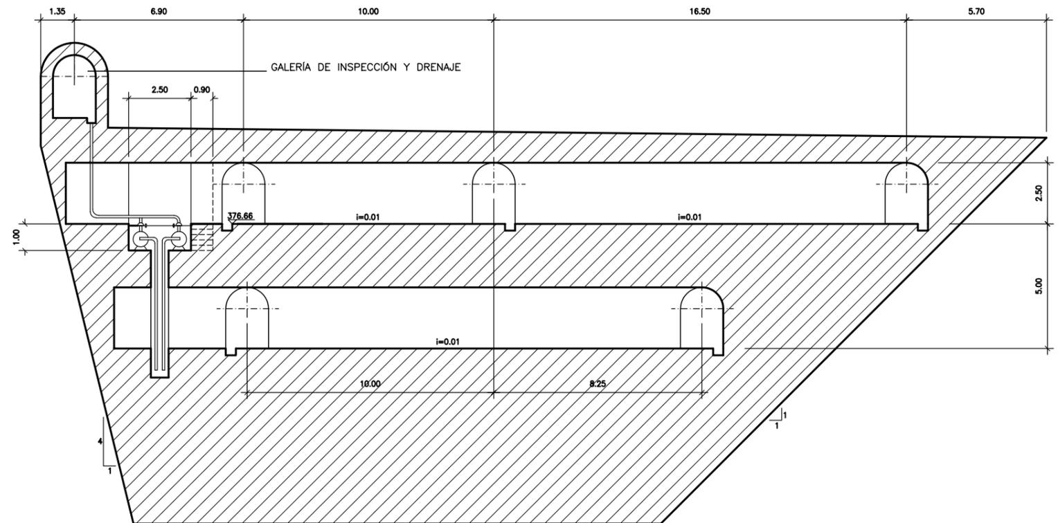
**SECCIÓN TRANSVERSAL TIPO DEL TAPÓN A-A**
