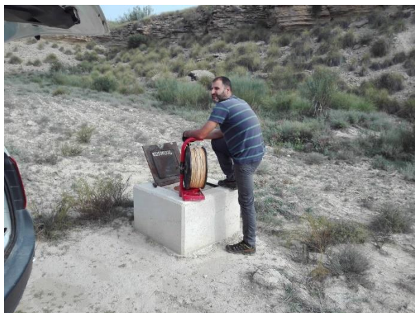
Figura 2.117. Piezómetro del Gorgotón. El piezómetro se usa como punto de referencia para saber la evolución piezométrica del manantial del Gorgotón, dada la cercanía y que el manantial no puede ser aforado directamente.
