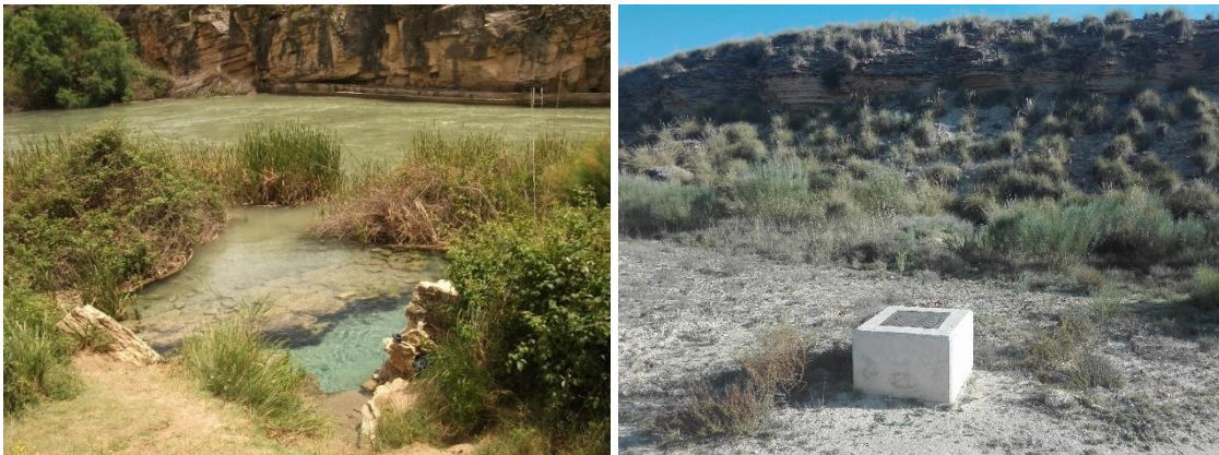
Figura 2.52. Manantial del Gorgotón. Las condiciones del nacimiento no permiten realizar un aforo. Se realiza un control indirecto mediante la medida del nivel piezométrico del sondeo próximo Gorgotón.
