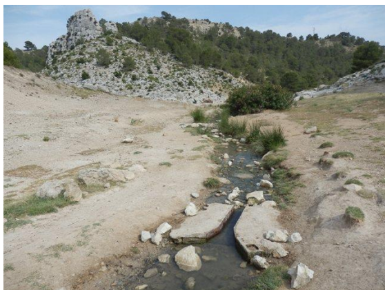
Figura 2.77. Fuente Caputa. La sección de aforos construida en 2008 se ha roto por las avenidas, así que hay que realizar una buena sección de aforos cada vez que se va a realizar la medida.
