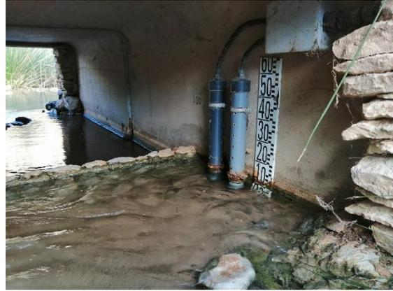
Escala y detalle del registro continuo instalado
