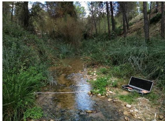
Sección de aforo aguas abajo del manantial
