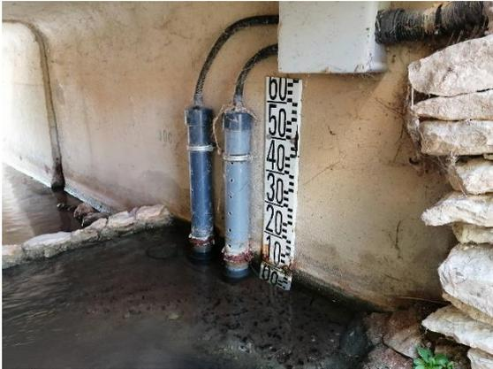
Escala y detalle del registro continuo instalado
