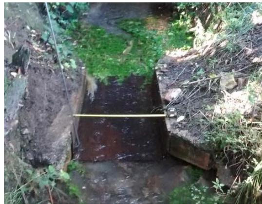
Foto 77. Vista de detalle del manantial y de la sección de aforos.
