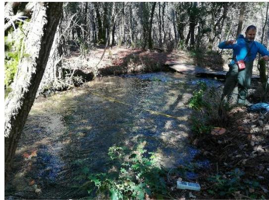
Foto 33. Charco de La Trucha. Imagen general del nacimiento y del aforo de caudal aguas abajo del azud del Charco de las Truchas.
