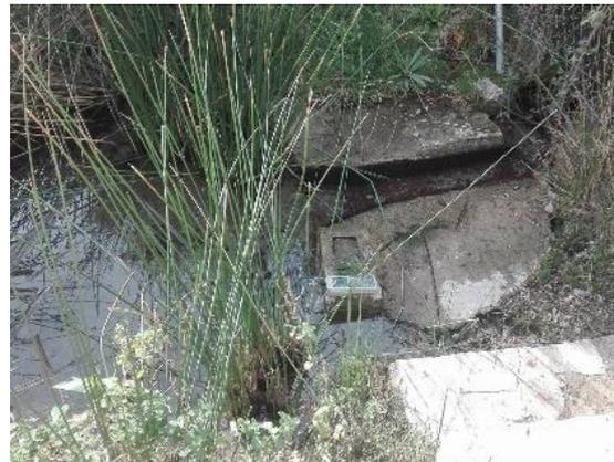
Foto 87. Imagen de detalle del manantial y el punto de aforo de la Fuente de Coy.
