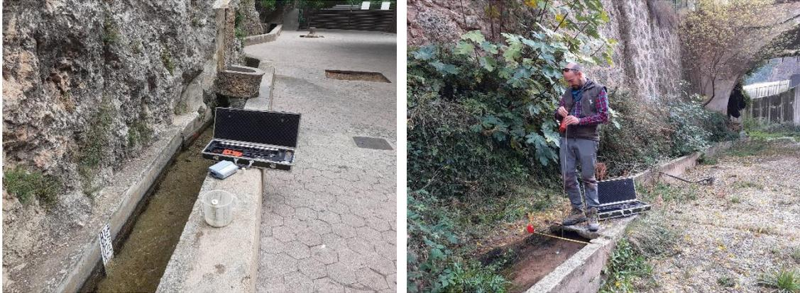
Foto 14. Fuente La Toba. Imagen de detalle de ambos aforos.
