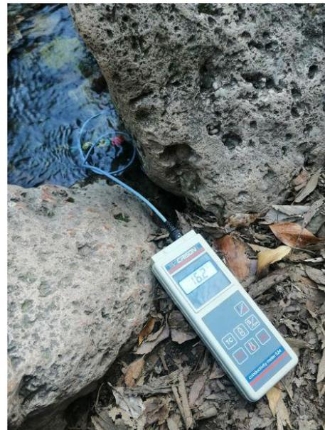
Foto 50. Vista de la surgencia del Charco Pataca y valores de conductividad y temperatura medidos a la salida del manantial.
