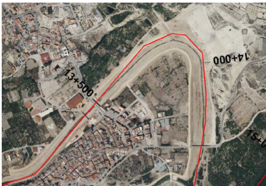
Figura 13: Trazado del río Mula a su paso por la localidad de Albudeite correspondiente al año 1.929 sobre la ortofoto actual.
