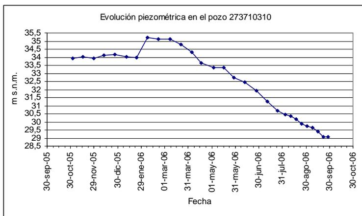
Figura 19. Evolución piezométrica del piezómetro Edificio Volante S
