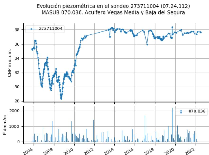
Figura 21. Evolución del nivel piezométrico en el sondeo 273711004, punto de control de la masa de agua Acuífero Vegas Media y Baja del Segura
