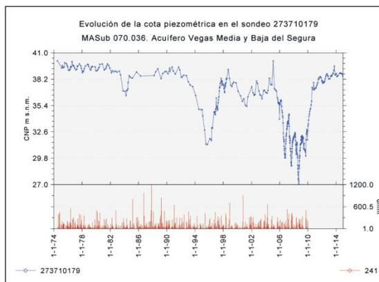
**Figura 12.** Evolución piezométrica en la MASub Vegas Media y Baja del Segura. En 2014 el estado cuantitativo mantiene una suave recuperación, con una posición de la superficie piezométrica muy alejada de los mínimos de la sequía 2005-2009.
