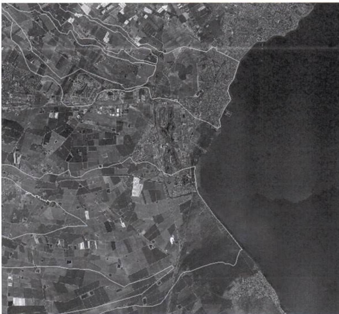
FIGURA 5. Zonas de flujo preferente de las ramblas de la Maraña y el Albuji3n. Lomas de Rame no tiene afecci3n de la rambla de la Maraña y apenas de la del Albuji3n.
