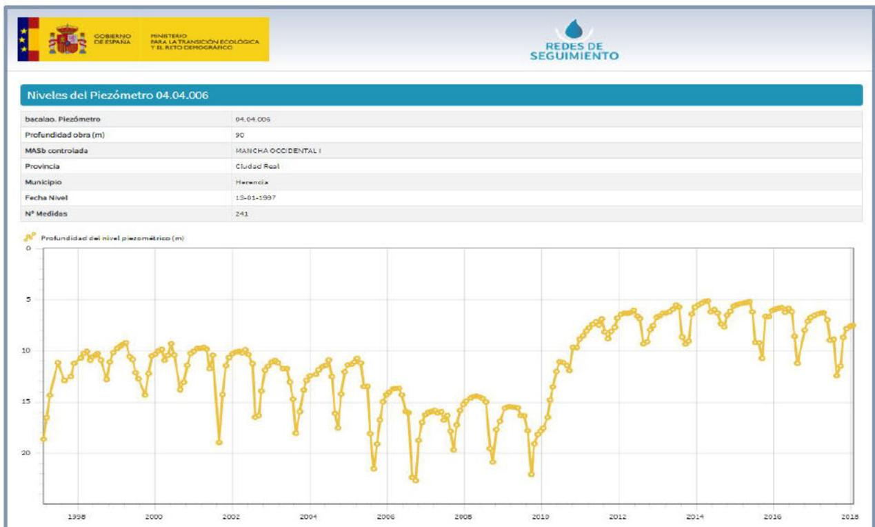
Figura 40 PIEZÓMETRO 04.04.006 (MASub Mancha Occidental I), cuenca del Guadiana)
