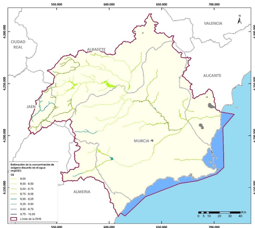
Figura 20. Estimación de la concentración de oxígeno disuelto en el agua (mgO<sub>2</sub>/l) calculada en función de la temperatura y la altitud en el mes de agosto
