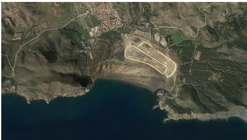
Figura 15. Vista aérea de la Bahía de Portmán, donde se aprecia la colmatación de la misma consecuencia de los vertidos de estériles mineros. Fuente: Google Earth.
