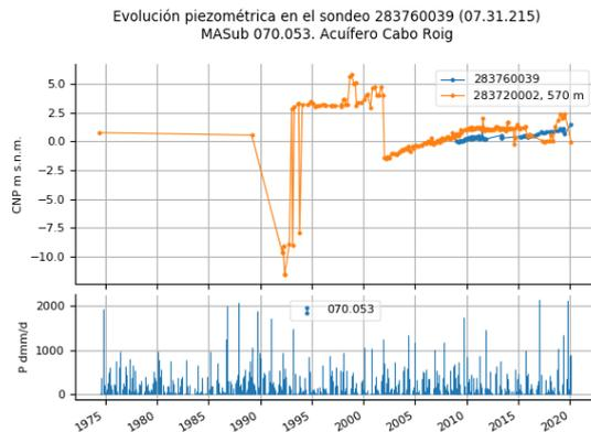
Figura 46. Evolución piezométrica la MSBT Cabo Roig
