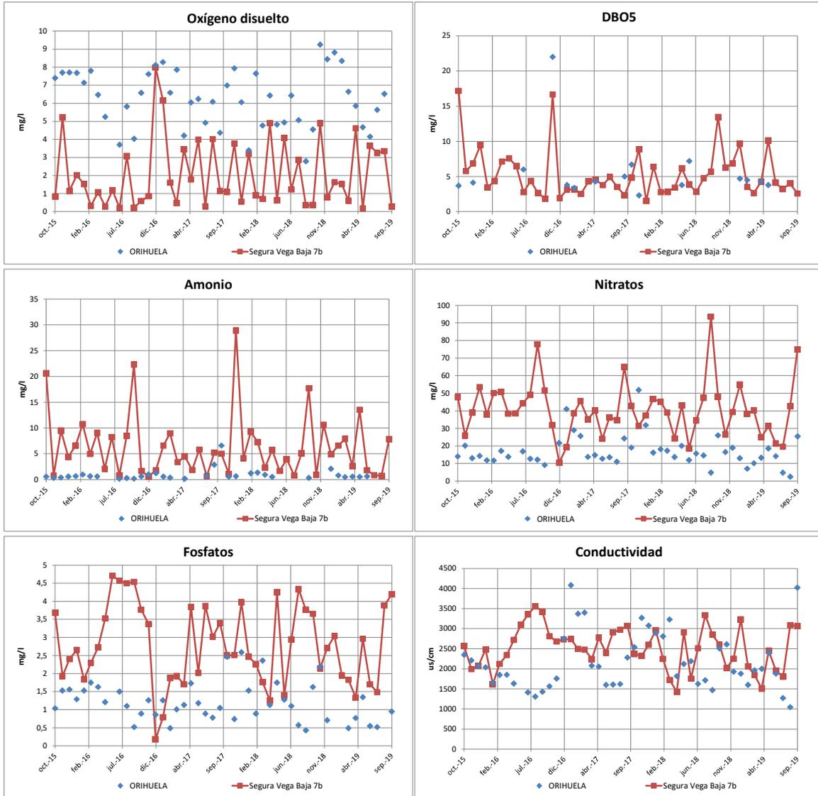
Figura 134. Comparativa de los valores medidos en la estación ICA Orihuela y los obtenidos con el modelo en el tramo correspondiente.
