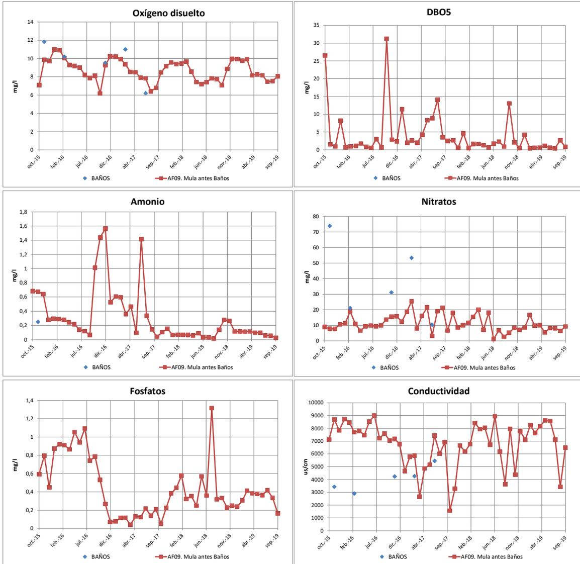
Figura 107. Comparativa de los valores medidos en la estación ICA Baños y los obtenidos con el modelo en el tramo correspondiente.
