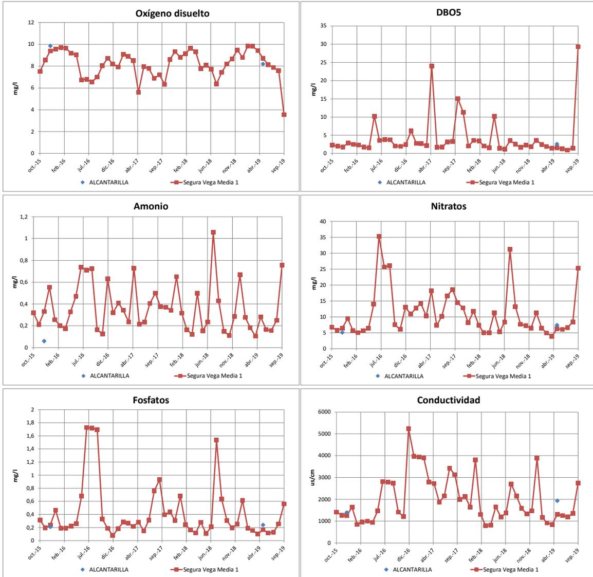
Figura 131. Comparativa de los valores medidos en la estación ICA Alcantarilla y los obtenidos con el modelo en el tramo correspondiente.
