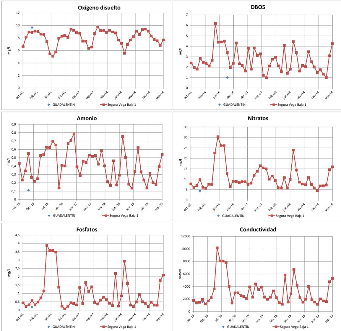
Figura 132. Comparativa de los valores medidos en la estación ICA Guadalestín y los obtenidos con el modelo en el tramo correspondiente.
