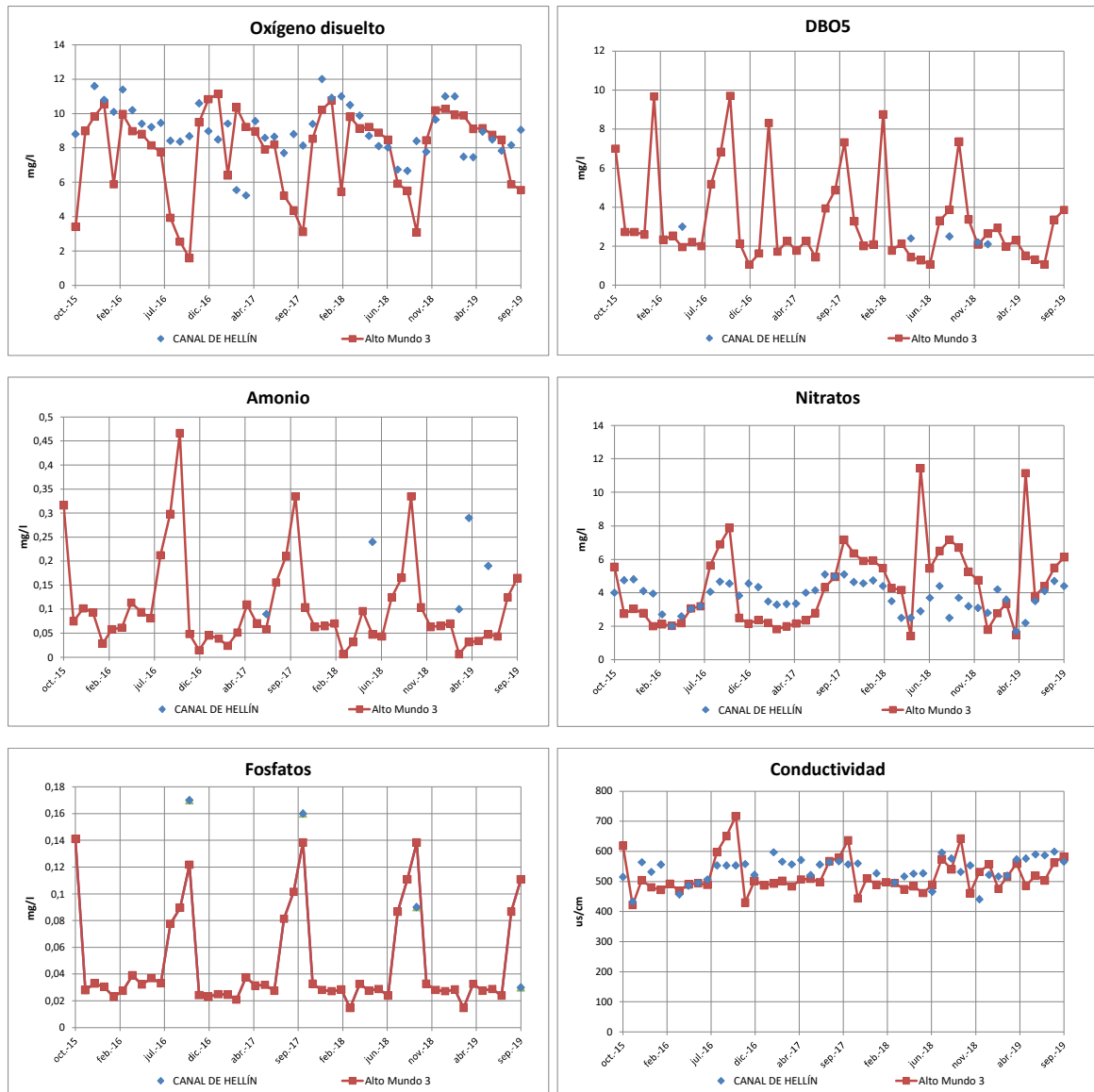
Figura 91. Comparativa de los valores medidos en la estación ICA Canal de Hellín y los obtenidos con el modelo en el tramo correspondiente.
