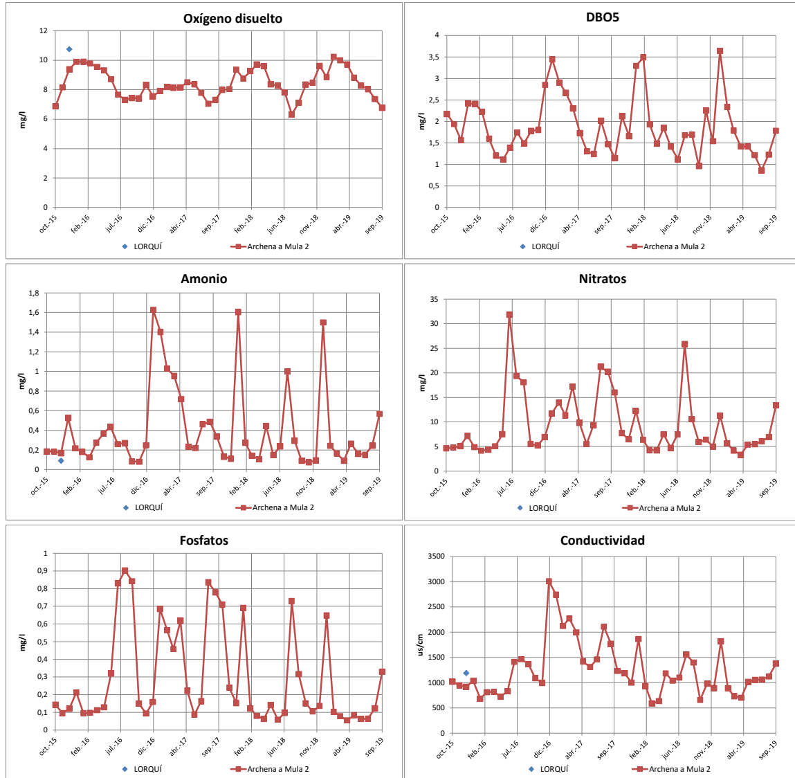
Figura 126. Comparativa de los valores medidos en la estación ICA Lorquí y los obtenidos con el modelo en el tramo correspondiente.
