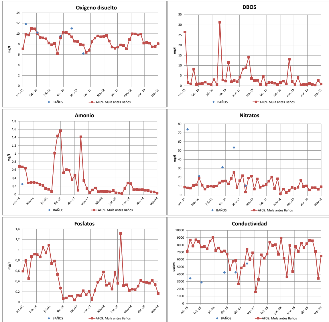
Figura 107. Comparativa de los valores medidos en la estación ICA Baños y los obtenidos con el modelo en el tramo correspondiente.
