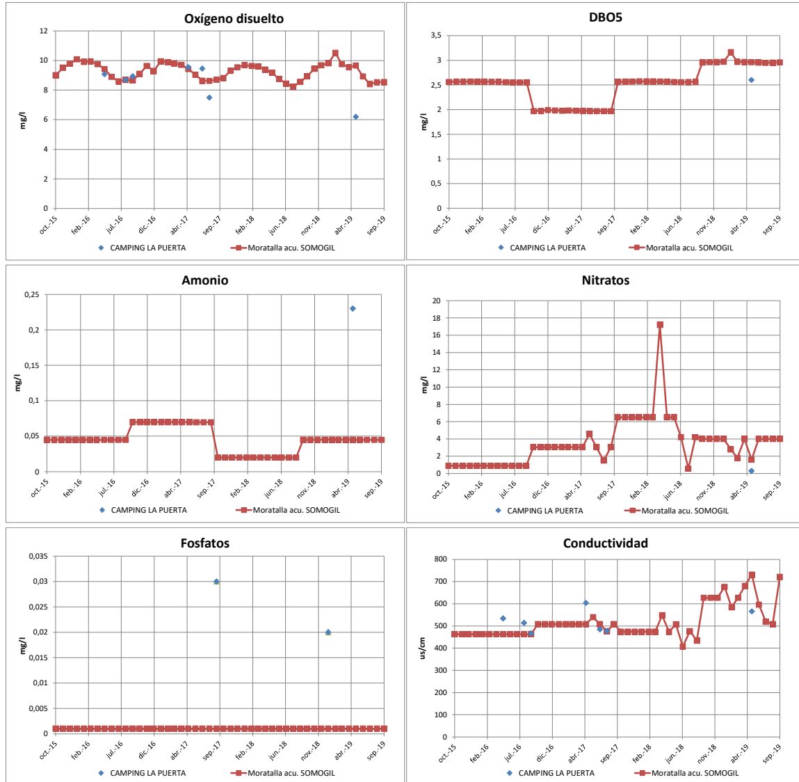
Figura 101. Comparativa de los valores medidos en la estación ICA Camping La Puerta y los obtenidos con el modelo en el tramo correspondiente.
