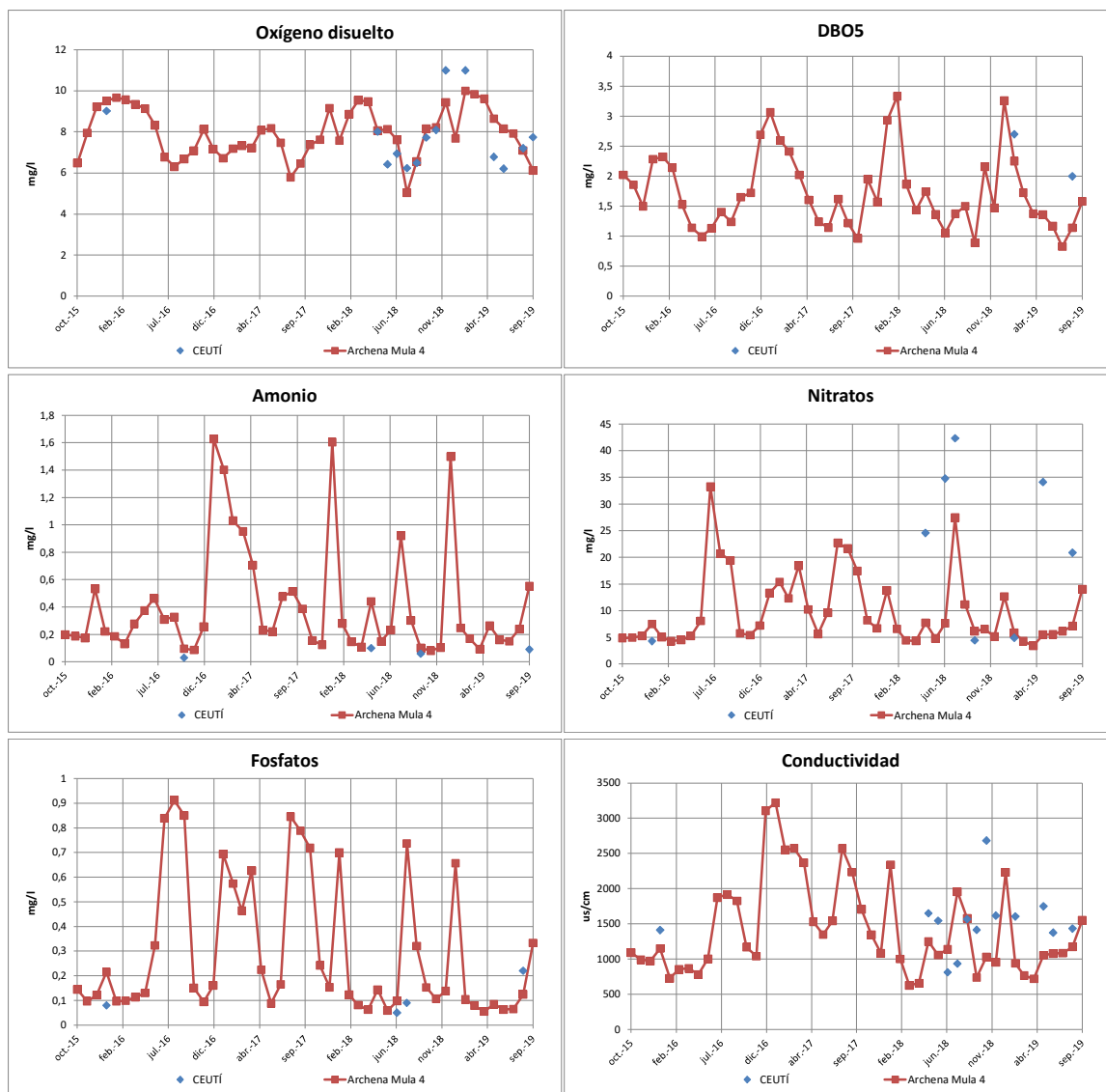
Figura 127. Comparativa de los valores medidos en la estación ICA Ceutí y los obtenidos con el modelo en el tramo correspondiente.
