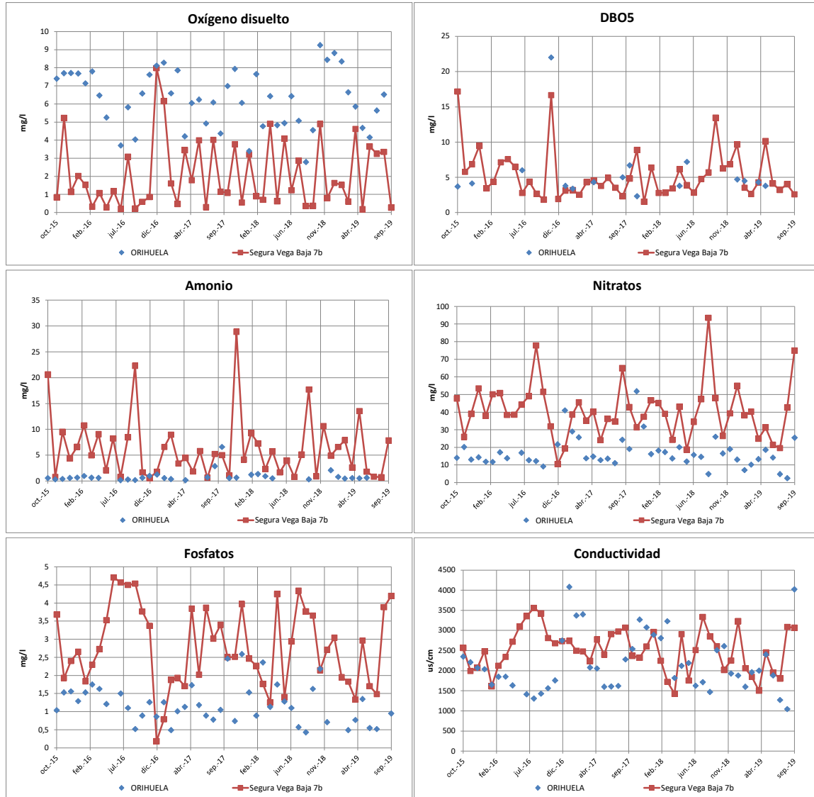
Figura 134. Comparativa de los valores medidos en la estación ICA Orihuela y los obtenidos con el modelo en el tramo correspondiente.
