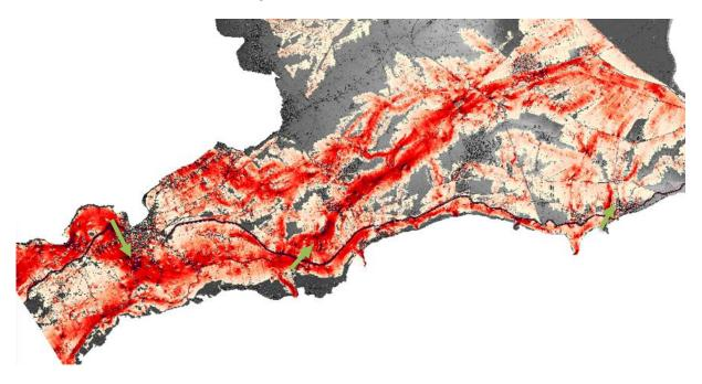
Figura 12. Velocidades de flujo. Las flechas marcan los 2 cruces de los flujos desbordados sobre el encauzamiento del río Segura de las márgenes desbordadas del río Segura. Fuente: elaboración propia.
