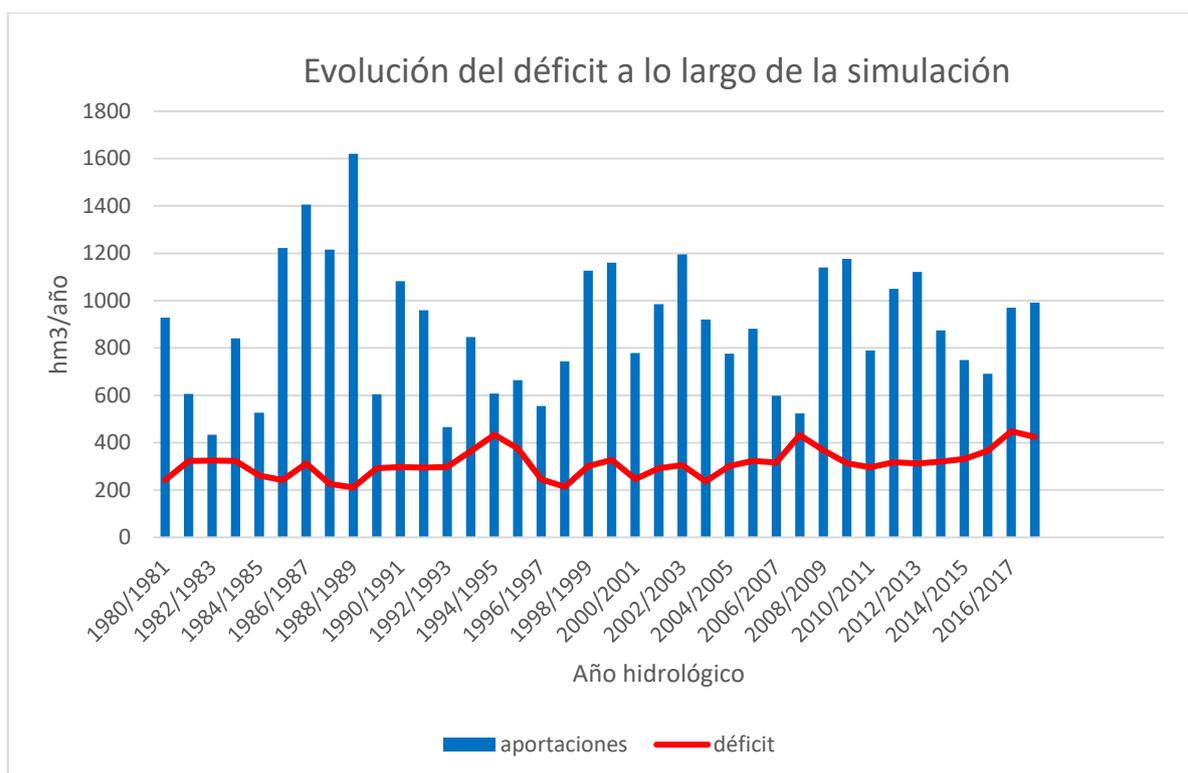
Figura 3. Evolución del déficit a lo largo de la simulación. Horizonte 2021. Periodo 1980/81-2017/18. ATS aplicando las vigentes reglas de explotación 1980/81-2017/18, 295 hm<sup>3</sup>/año
