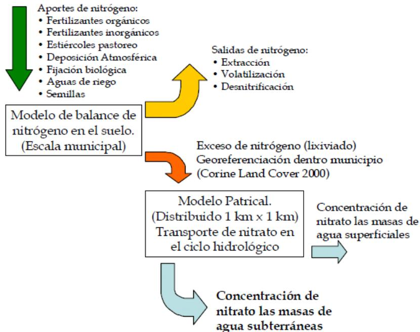
Figura 3. Metodología de análisis con el empleo de los dos modelos de simulación. Fuente: “Evaluación de los objetivos de concentración de nitrato en las masas de agua subterráneas de España (2015 2021 y 2027) con el modelo de simulación Patrical” (DGA, diciembre 2014).
