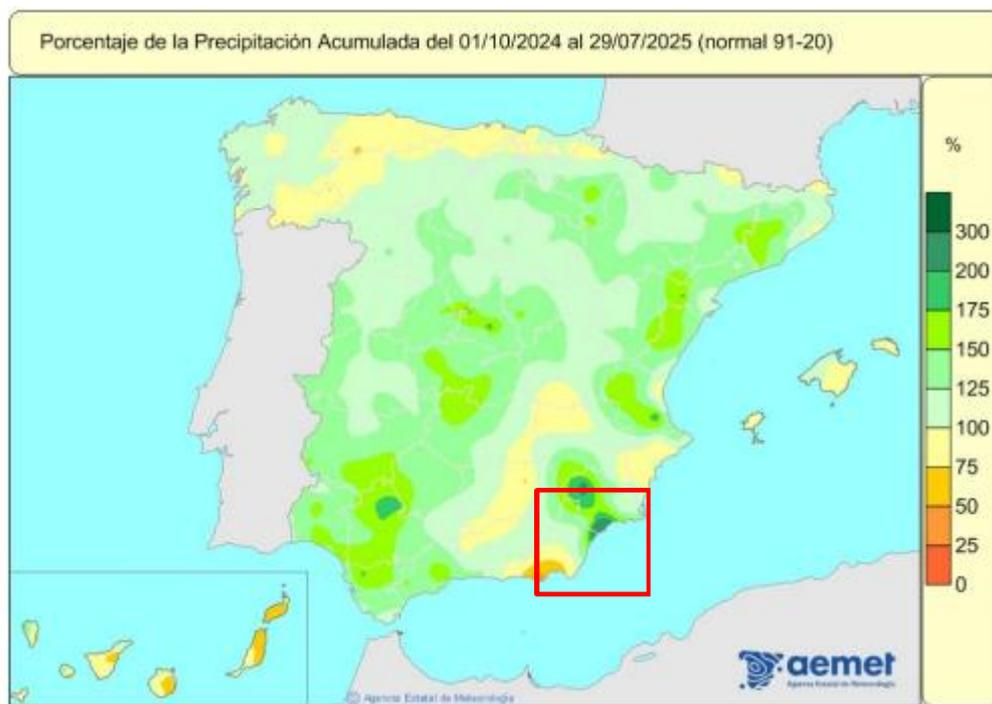
La imagen inferior muestra una ampliación del mapa de AEMET para el ámbito de la Demarcación Hidrográfica del Segura. Se puede observar que las cantidades acumuladas se encuentran por encima de sus valores normales especialmente en la margen derecha de la cuenca donde las cantidades duplican esos valores.
